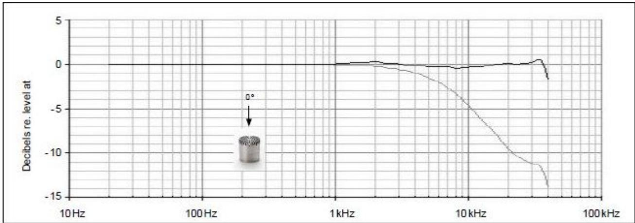
典型的频率响应。上曲线显示0°时的自由场响应，下曲线显示压力响应。
