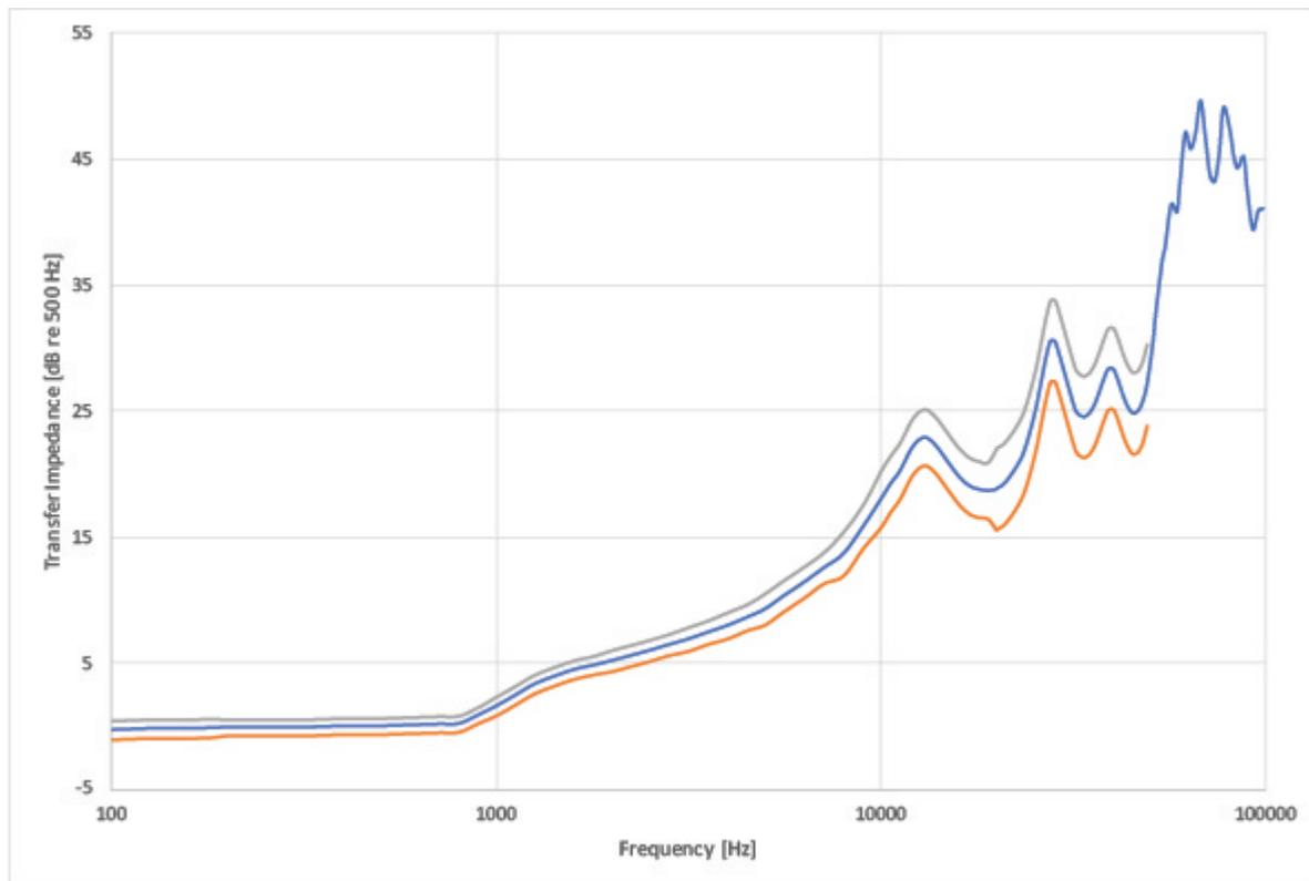
图1. 典型 RA0404 高解析度仿真耳的传输阻抗 (含公差)。在 10 kHz 以下, 响应在 IEC 60318-4 定义的限值内。在 10 kHz 以上, 响应在直至 50 kHz 的一个相当窄的公差带内。
